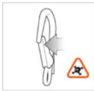
Dwarsbelasting op de sluiting
